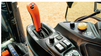
2. Main shift 8 range power shift
