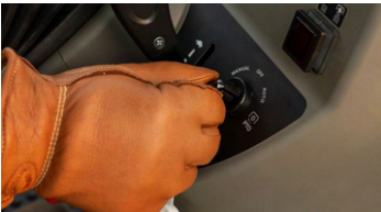
1. PTO mode switch (OFF, MANUAL, AUTO)
