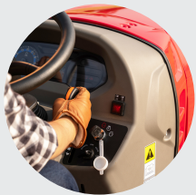
1. Automatische Drehzahlregelung 2. Automatischer Zapfwellenhebel
