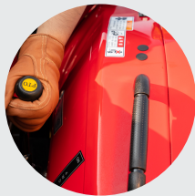
1. Automatische Drehzahlregelung 2. Automatischer Zapfwellenhebel
