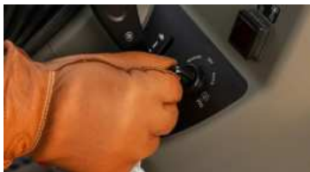
1. PTO mode switch (OFF, MANUAL, AUTO)
