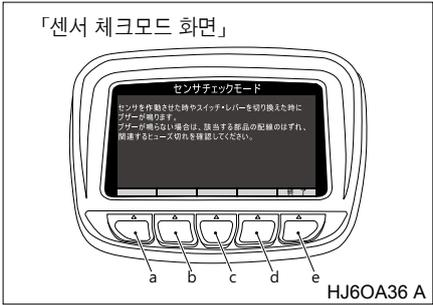
(2) 센서 체크모드가 되면서 센서, 스위치, 레버 등을 체크할 수가 있습니다. 각 센서와 스위치, 레버를 다음 항의 체크방법에 따라서 체크합니다. 정상인 경우에는 센서를 작동시켰을 때나 스위치, 레버 등을 전환했을 때에 부저가 울립니다.
