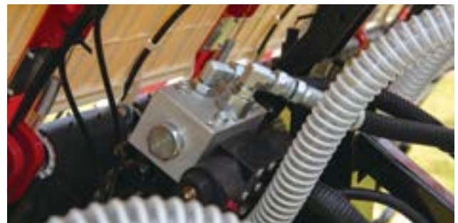
유압식 수평제어(TBS) 유압식 수평제어(TBS)를 적용하여 반듯하게 모를 심을 수 있습니다.
