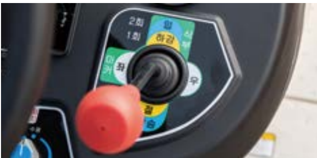
전자식 레버 적용 식부부 입/절, 상승/하강을 전자식 레버로 조작하여 장시간 작업에도 편리합니다.
