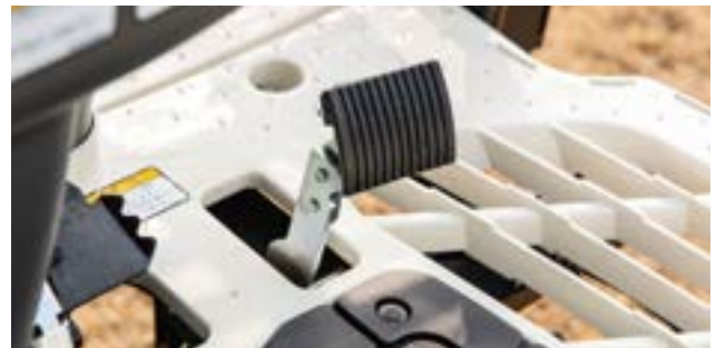
페달 변속(HMT 방식) 자동차와 같이 페달로 변속이 가능합니다.
